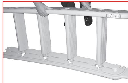
No 7 : Soulever ou basculer, puis aligner les tenons pour les insérer dans les mortaises du montant.
