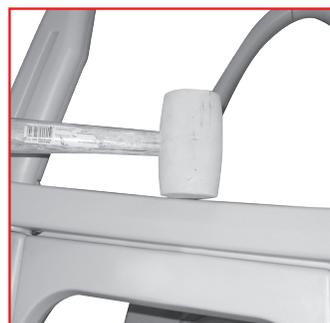
No 9 : Frapper doucement la plateforme pour bien l'enfoncer jusqu'aux ponts.
