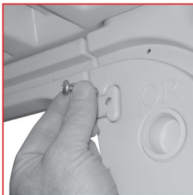
No 8 : Utiliser les vis à métaux ¼ po n° 20 de 1 po et les écrous hexagonaux ¼ po n° 20 fournis pour fixer les tenons extérieurs aux montants marqués OL et OR de l'échelle extérieure. Passer les vis à partir de l'intérieur et boulonner à l'extérieur au moyen des écrous hexagonaux. S'il faut finir de percer les trous des vis, utiliser une perceuse à batterie et une mèche de 5/16 po.
